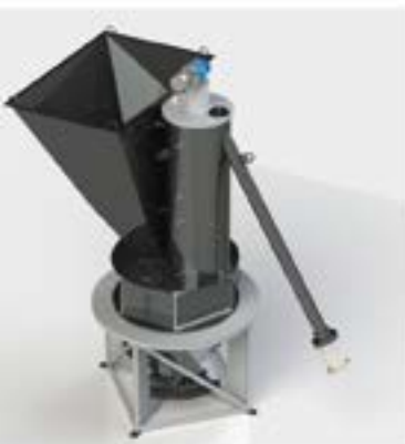
Особо компактная печь для обжига мелкодисперсной извести "Вулкан"
