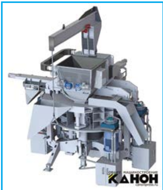
Рис. 4. Автоматический 4-позиционный револьверный пресс полусухого прессования П3200-Патриот
