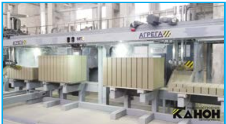
Рис. 3. Автоматизированная линия для производства высококачественных облицовочных изделий на известковом вяжущем карбонатного твердения
