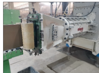
Рис. 5. Успешная реализация проекта установки экструдера «Вердес» модели «Экзакта» на предприятии Cerámicas Mora (Тоledo, Испания) и на одном из предприятий Новочебоксарска
